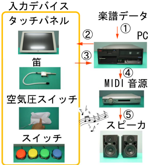
図1 楽器サイミスの構成 楽譜を内蔵しているので Cymis (Cyber Musical Instrument with Score) (サイミス) と呼びます。
